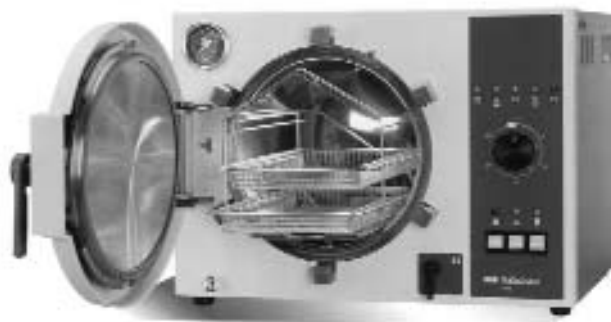
Figura 1. Miniclave MATACHANA modelo 21EX, con ciclos de tipo N.
